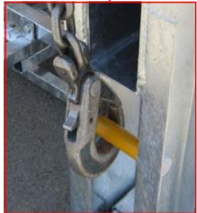
Levage avant sur ossature
